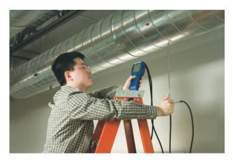
Staurohre sind anerkannte Sensoren zur Messung der Strömungsgeschwindigkeit von Luft und Gasen. Sie eignen sich zur Messung der
