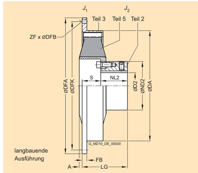
Die Demontage des Gummischeibenelements ist erst nach Verschieben der Maschinen möglich.
