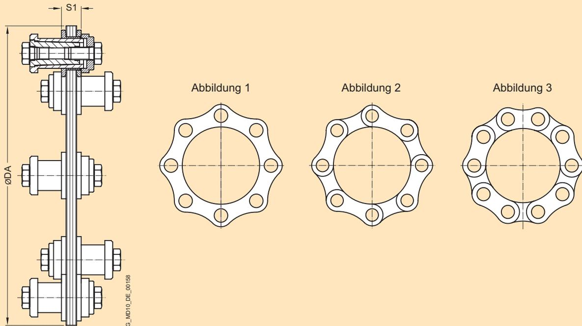
Die Lamellenpakete der Baureihe ARC-8 werden bis Baugröße 595-8 mit Ringlamellen (Abb. 1) und ab Baugröße 630-8 mit Laschenlamellen ausgeführt (Abb. 2).
