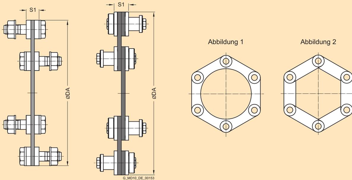
Die Lamellenpakete werden bis Größe 255-6 mit Ringlamellen (Abb. 1) und ab Größe 280-6 mit Laschenlamellen ausgeführt (Abb. 2).
