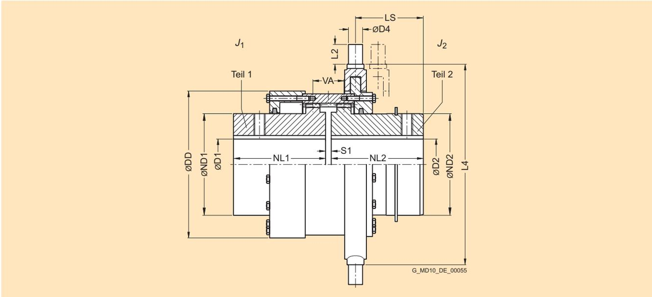
Im Stillstand schaltbar. Gleitflächen vor Verschmutzung und Korrosion schützen; mit Haftfett eingesprüht.
