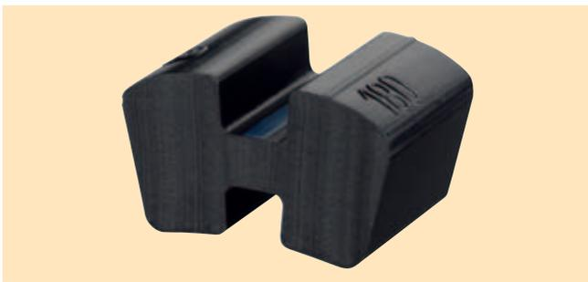
Die Pakete der N-EUPEX Kupplung werden druckbeansprucht. Bei Zerstörung der Pakete findet Metallkontakt der Nabenteile statt. Diese „Notlaufeigenschaft“ wird z. B. bei Feuerlöschpumpen gefordert.
