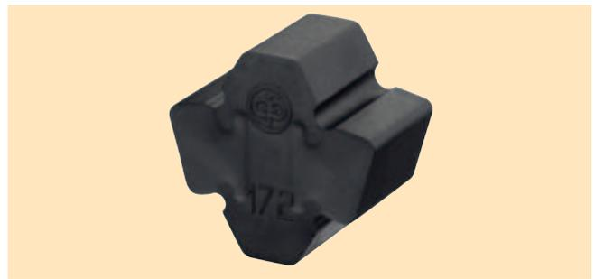
Die Pakete der N-EUPEX DS Baureihe werden druck- und biegebeansprucht. Bei Zerstörung der Pakete drehen sich die Metallteile ohne Kontakt gegeneinander, die Kraftübertragung ist getrennt. Durch den Einbau neuer Pakete ist die Kupplung wieder verwendungsfähig.
