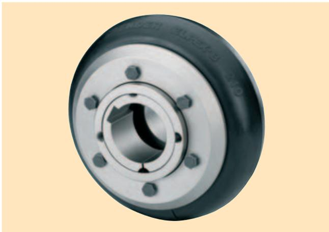
ELPEX-B Kupplungen sind hochdrehelastisch und verdrehspielfrei. Aufgrund ihrer niedrigen Torsionssteifigkeit und ihres Dämpfungsvermögens eignet sich die ELPEX-B Kupplung besonders zur Koppelung von Maschinen mit stark ungleichförmigem Drehmomentverlauf. Zudem sind ELPEX-B Kupplungen zur Verbindung von Maschinen mit großem Wellenversatz geeignet.
