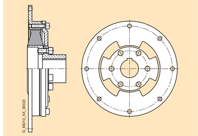
Die ELPEX-S Kupplung kann auch mit Durchschlagsicherung ausgeführt werden. Bei Ausfall des Gummischiebenelementes kann die Kupplung noch über einen kurzen Zeitraum im Notbetrieb verwendet werden. Diese Option wird z. B. bei Schiffsantrieben häufig gefordert.
