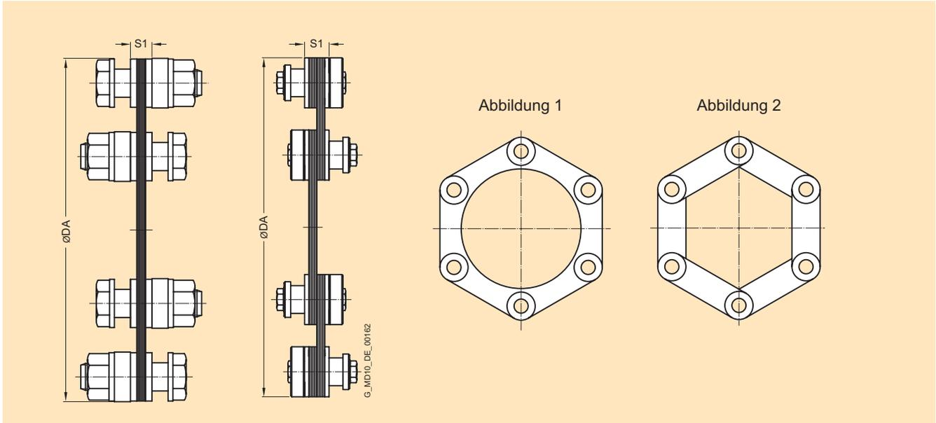
Für die Lamellenpakete werden überwiegend Ringlamellen (Abb. 1) verwendet. Die Größen 298-6 und 325-6 werden mit Laschenlamellen ausgeführt (Abb. 2).
