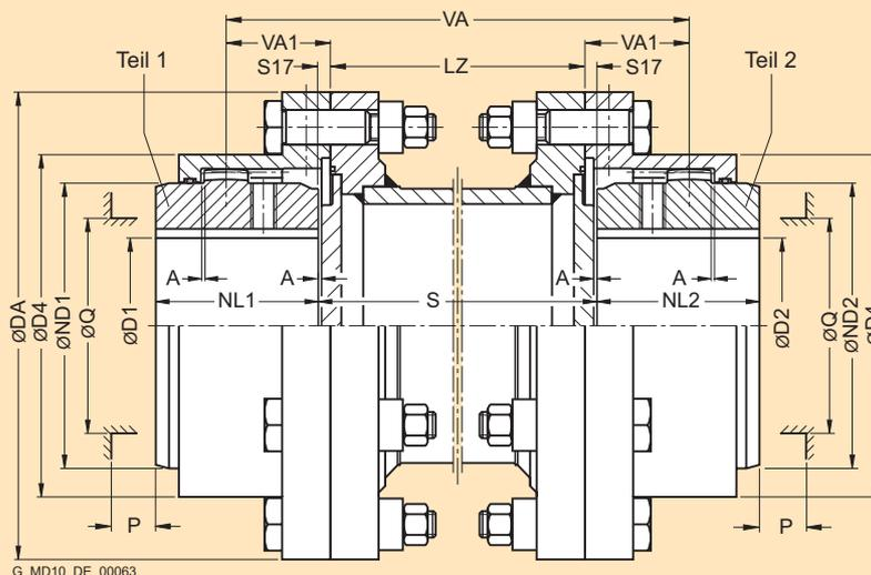
In der Auslenkung und Axialbewegung eingeschränkte Ausführung. Auslenkung max. 0,2°.
