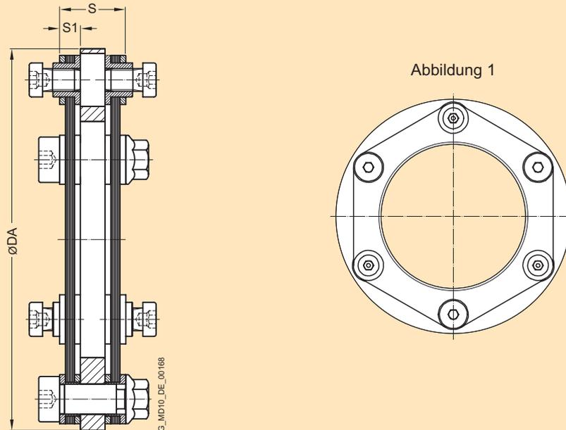
Die Lamellenpakete werden mit Ringlamellen (Abb. 1) ausgeführt.
