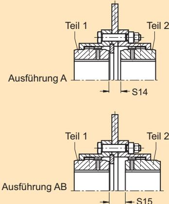
In der Auslenkung und Axialbewegung eingeschränkte Ausführung. Auslenkung max. 0,2°.
