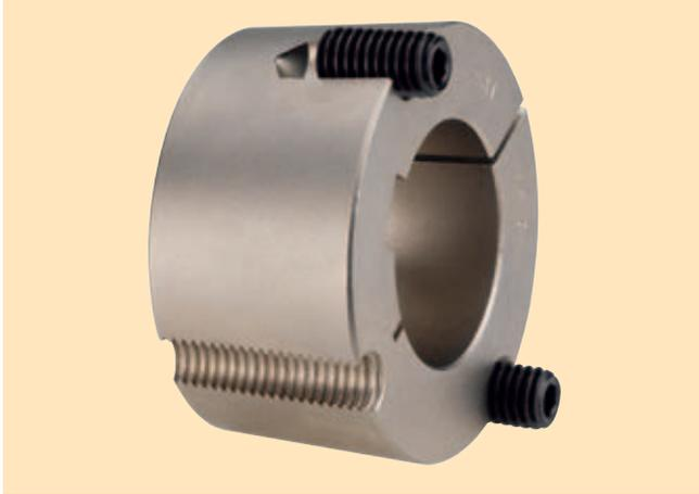
Taperspannbuchsen sind Maschinenelemente, die eine Maschinenwelle mit einem Nabenteil form- und kraftschlüssig verbinden. Die Maschinenwelle ist zylindrisch mit Nut auszuführen. Das Nabenteil muss eine konische Aufnahmebohrung mit speziellen Gewinden und Abdrückbohrungen besitzen.
