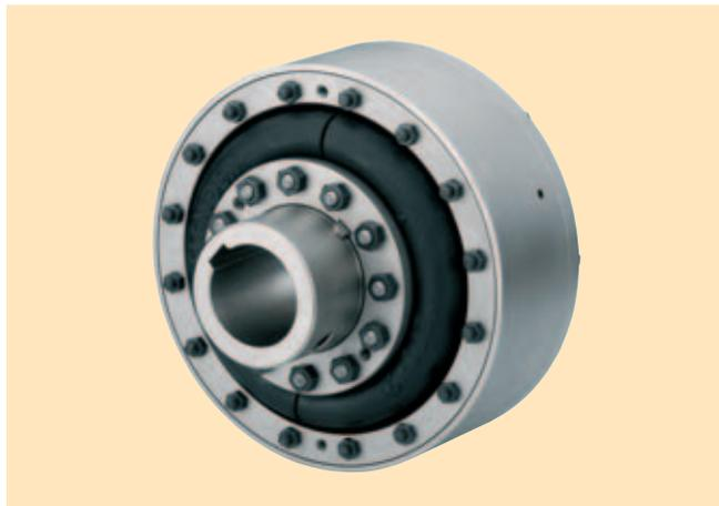
ELPEX Kupplungen sind hochdrehelastisch und verdrehspielfrei. Aufgrund ihrer niedrigen Torsionssteifigkeit und ihres Dämpfungsvermögens eignet sich die ELPEX Kupplung besonders zur Koppelung von Maschinen mit stark ungleichförmigem Drehmomentverlauf. Zudem sind ELPEX Kupplungen zur Verbindung von Maschinen mit großem Wellenversatz geeignet.
