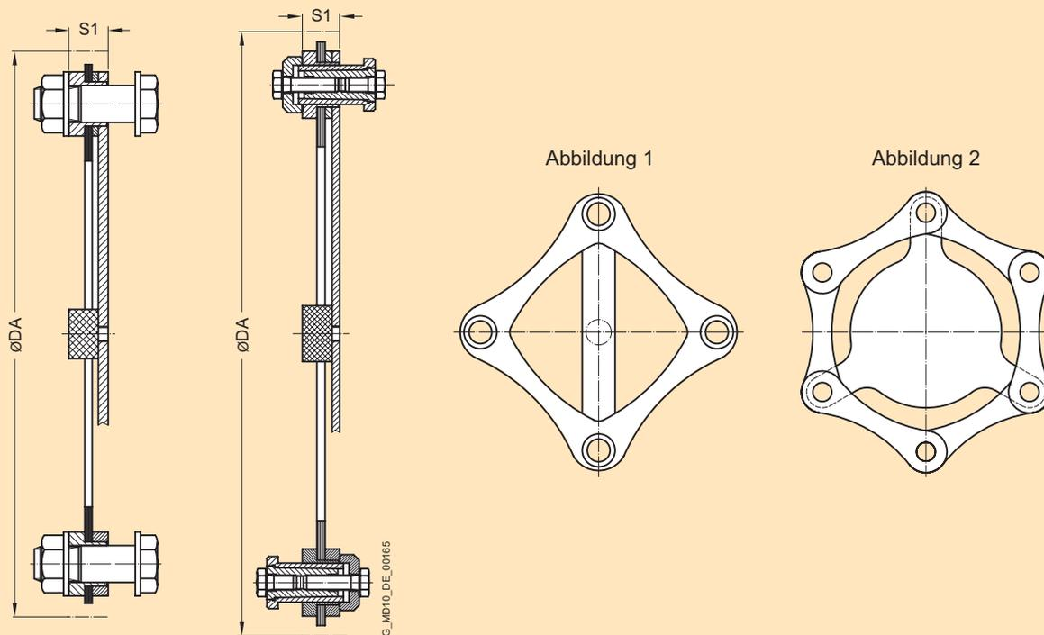
Die Lamellenpakete der Baureihe ARW-4 werden mit Ringlamellen (Abb. 1) und die der Baureihe ARW-6 mit Laschenlamellen ausgeführt (Abb. 2).
