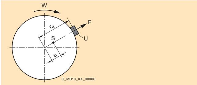
Die Unwuchtkraft steigt linear mit dem Abstand von Körperschwerpunkt zur Rotationsachse, dem Körpergewicht und mit der Rotordrehzahl zum Quadrat.
