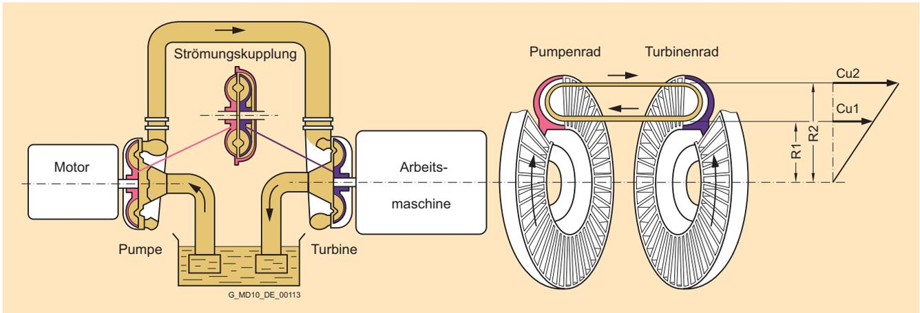
In einem flüssigkeitsdichten Gehäuse sind zwei sich gegenüberstehende, radial beschauelte Laufräder untergebracht. Die Laufräder sind nicht mechanisch miteinander verbunden. Die Drehmomentübertragung ist auf Grund der achsparallel angeordneten Schaufeln drehrichtungsunabhängig und erfolgt ausschließlich über die Flüssigkeitsfüllung.
