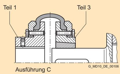
Teil 3: Verschraubung der Taperspannbuchse von der Wellenspiegelseite
