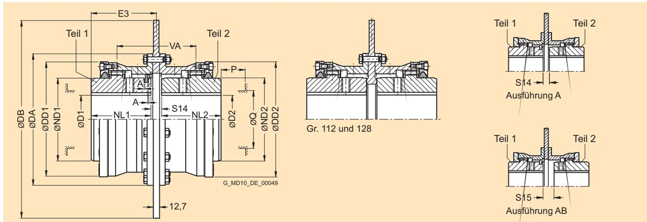
In der Auslenkung und Axialbewegung eingeschränkte Ausführung. Auslenkung max. 0,2°.
