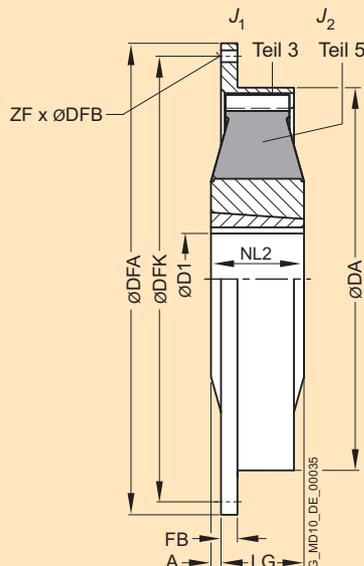
Die Demontage des Gummiseibenelements ist erst nach Verschieben der Maschinen möglich.
