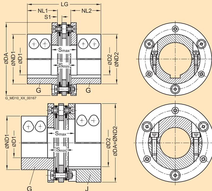
Die Wellentoleranz ist bei Bestellung zwingend anzugeben. Die Angabe erfolgt mit **-Z** an der Bestell-Nr. und den Kurzangaben Y26 und Y27 mit Klartextangabe der Wellentoleranz für D1 und D2.
