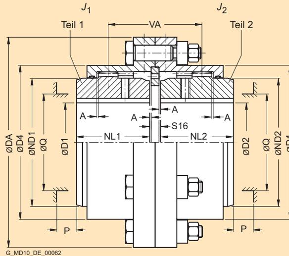
In der Auslenkung und Axialbewegung eingeschränkte Ausführung. Auslenkung max. 0,2°.
